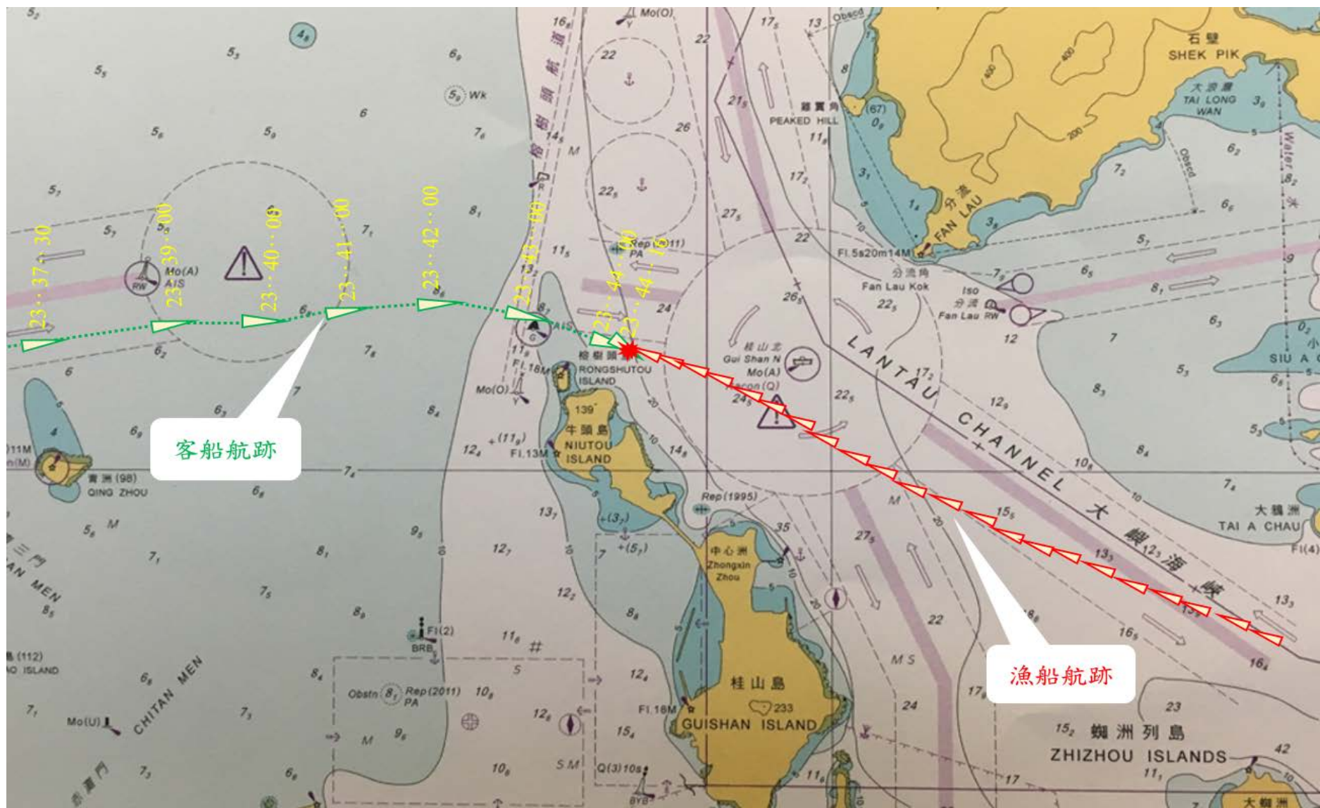
圖 6. 客船和漁船在碰撞事故發生前的航行軌跡及發生碰撞事故位置
