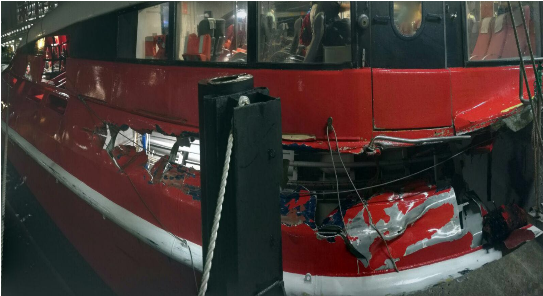
圖 7. 客船左舷 2 號和 3 號空艙外板破損
