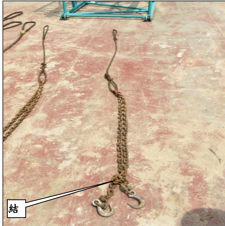
圖 10：吊第三碼貨時，經過調整長度後用於一端的一對鏈鉤。
