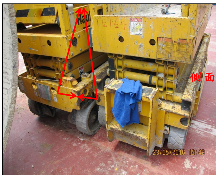
圖 4：另外一端的鏈鉤掛於內檔的繫固點
