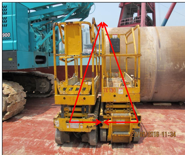
圖 3：其中一端的鏈鉤掛於外檔的繫固點
