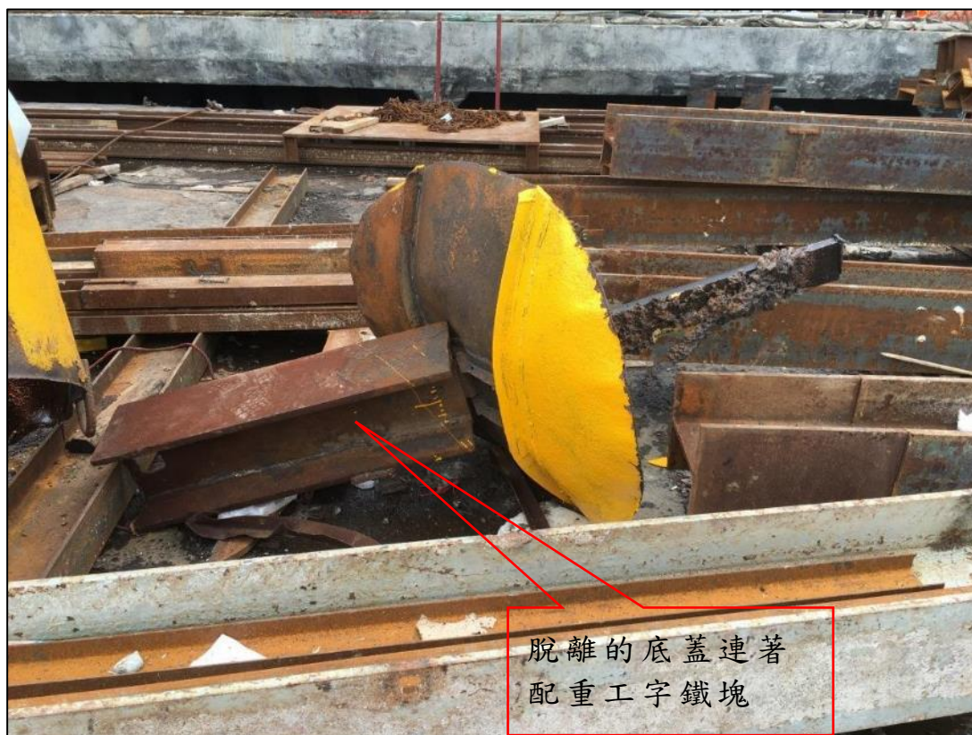
圖 5：爆炸後，脫離的底蓋連著配重工字鐵塊
