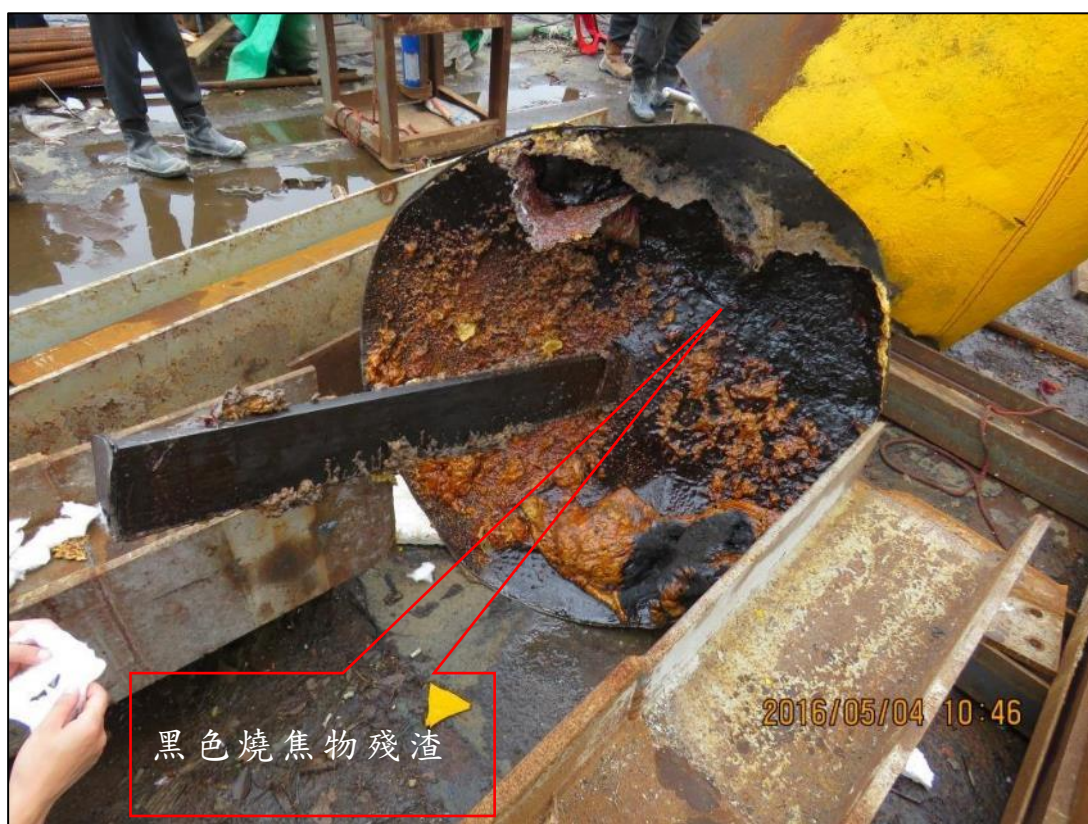
圖 6：燃燒後的填塞物殘餘（黑色燒焦物）附著在底蓋內
