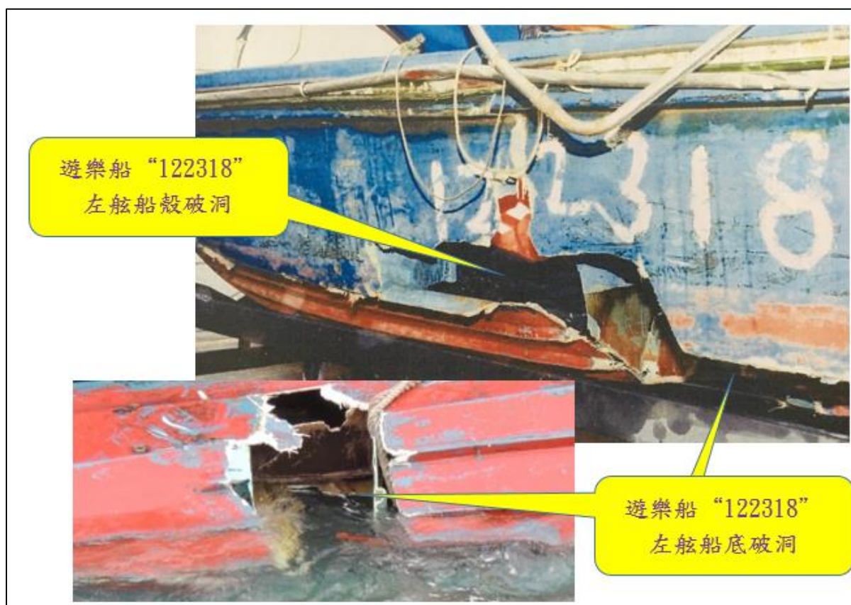
圖 4. 遊樂船在碰撞事故發生後的破損情況
