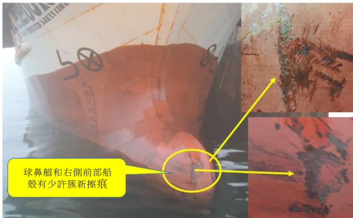
圖 5. 漁船的球鼻艏和右側前部船殼有少許簇新擦痕
