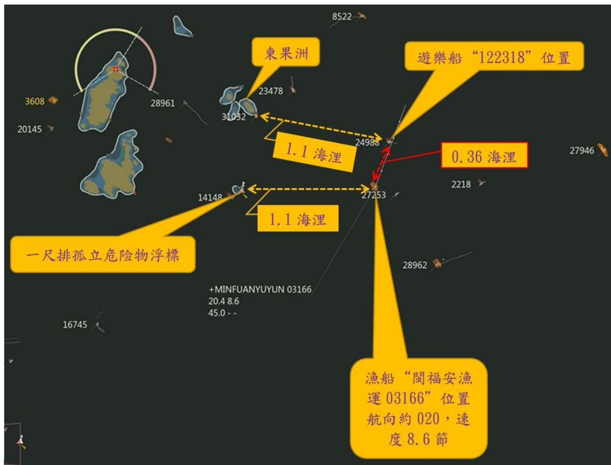
圖 8. 遊樂船和漁船在 2016 年 3 月 18 日約 1407 時的相對位置示意圖（截自雷達錄像記錄）
