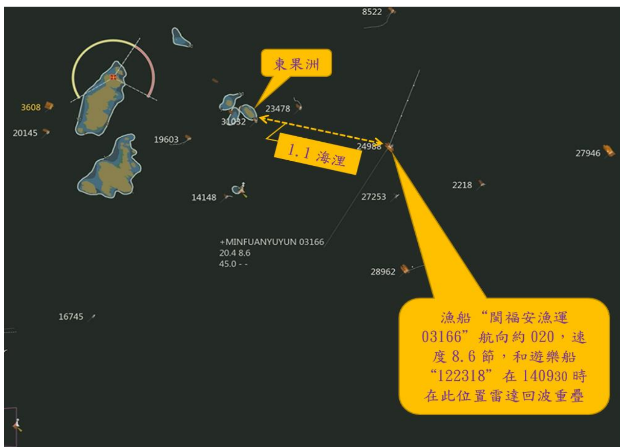
圖 9. 遊樂船和漁船的雷達回波在 2016 年 3 月 18 日約 1409 30 時重疊（截自雷達錄像記錄）
