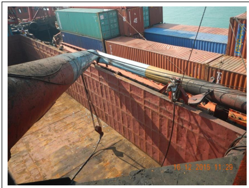
圖 8：吊臂摺曲並橫臥於“光輝”的左舷旁，而下半段仍然指向原來集裝箱的方向。
