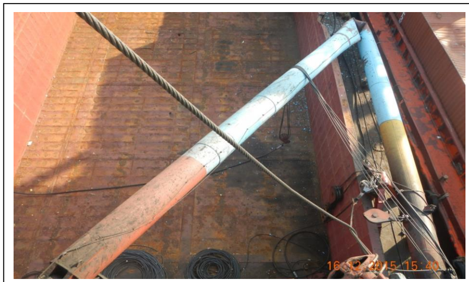
圖 21：吊臂中斷摺曲
