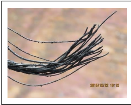
圖 17：斷掉的 28 毫米直徑鋼絲纜索
