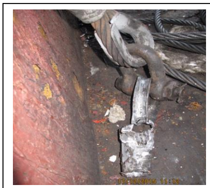
圖 19：28 毫米直徑鋼絲纜索飛 脫出來的吊環
