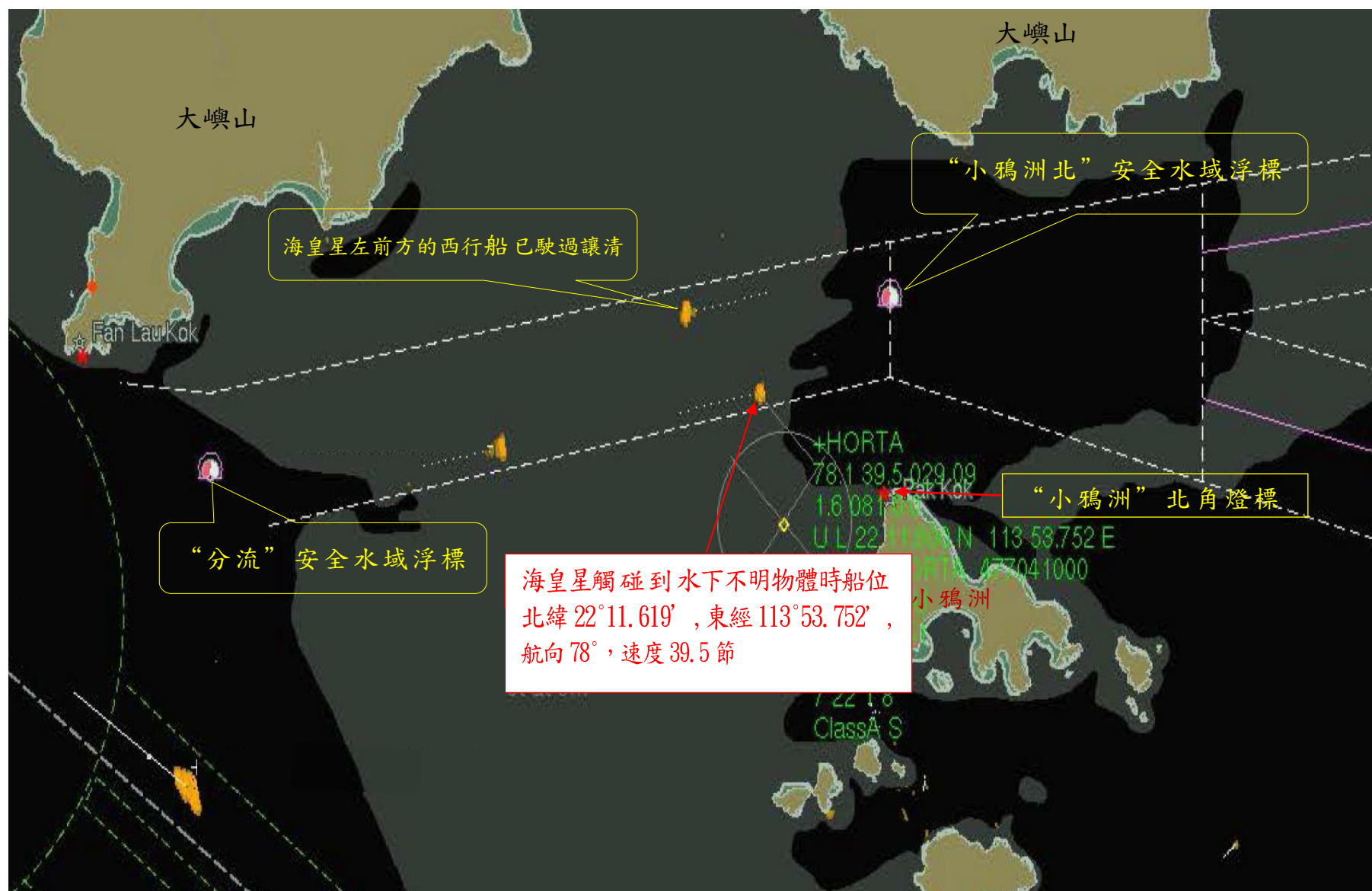
圖 7. 海事處船隻航行監察中心記錄海皇星在觸碰到不明物體時的雷達畫面。
