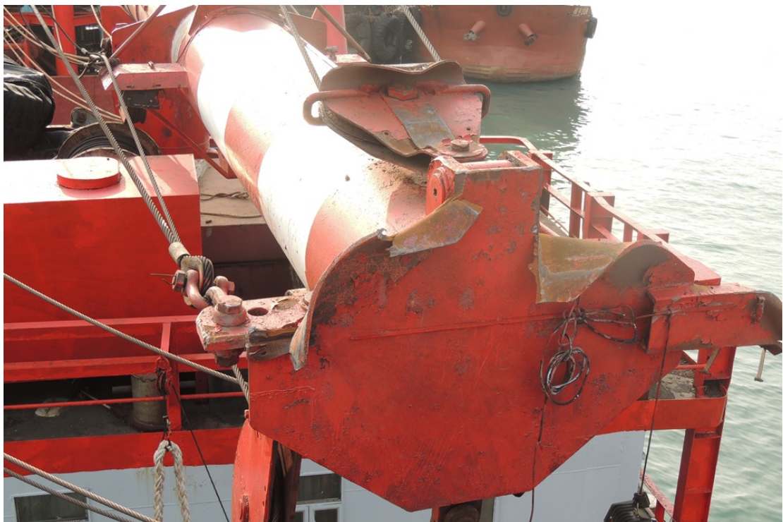
圖 7-躉船“新財威 8”吊臂頂端發現損毀
