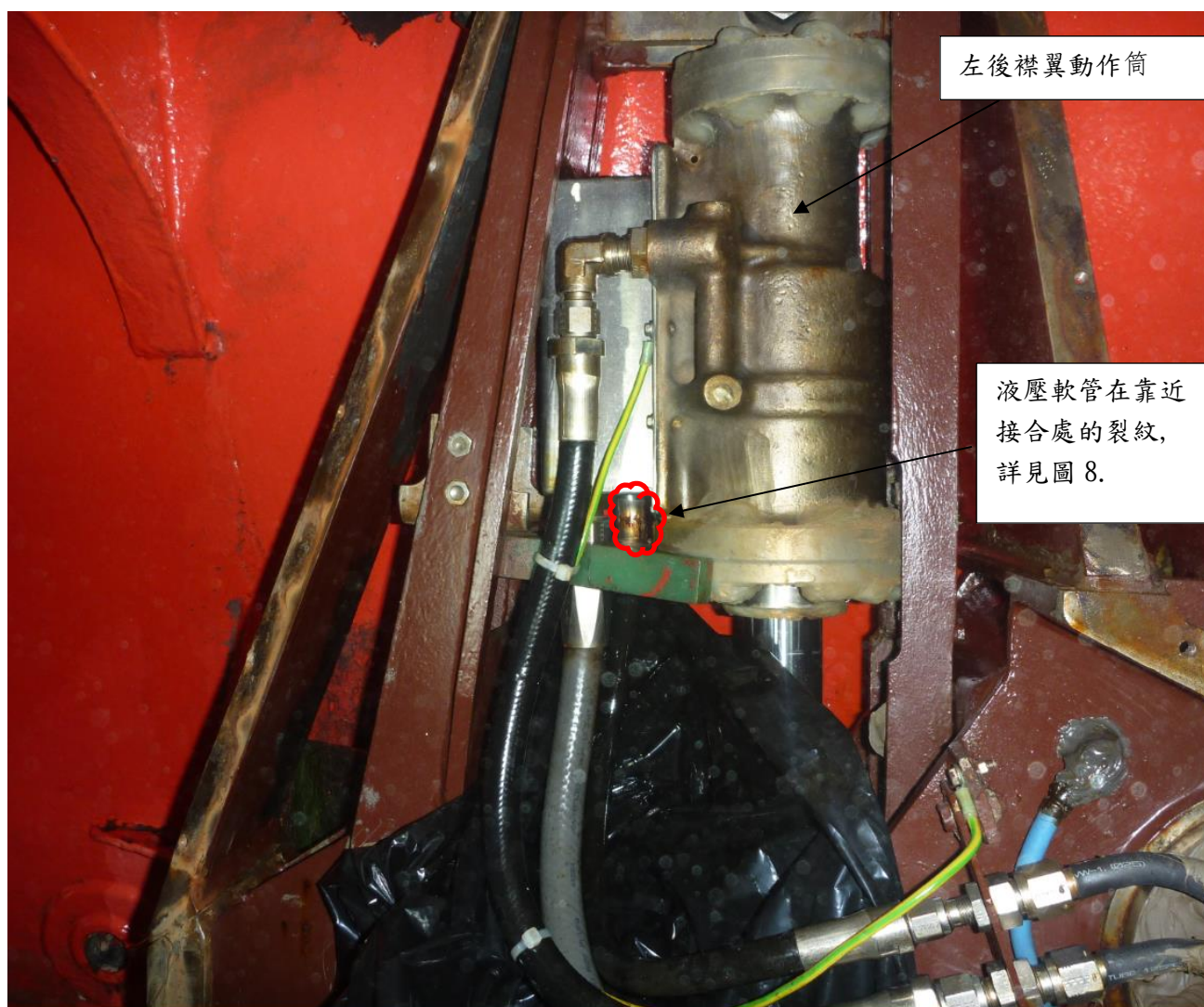
圖 7. 左後襟翼動作筒和液壓軟管
