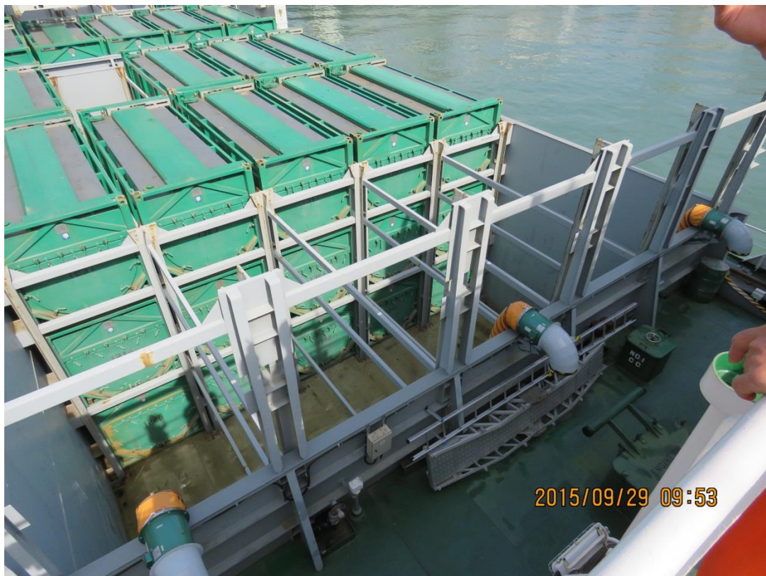
圖 5 -船艙的軸流式風扇
