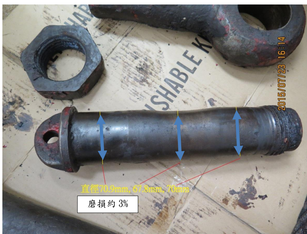
圖 7 - D 形接環的銷子磨損約 3%
