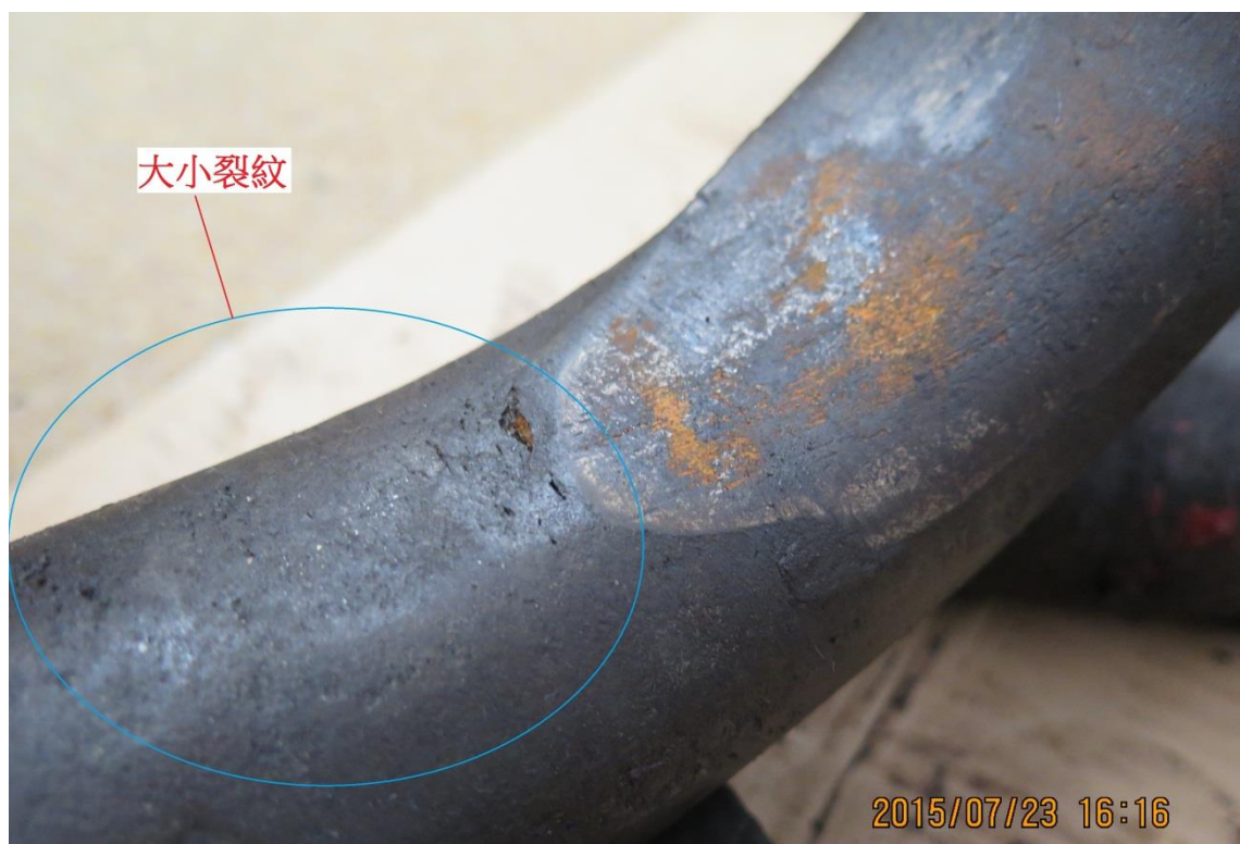
圖 6 - D 形接環上的明顯裂痕
