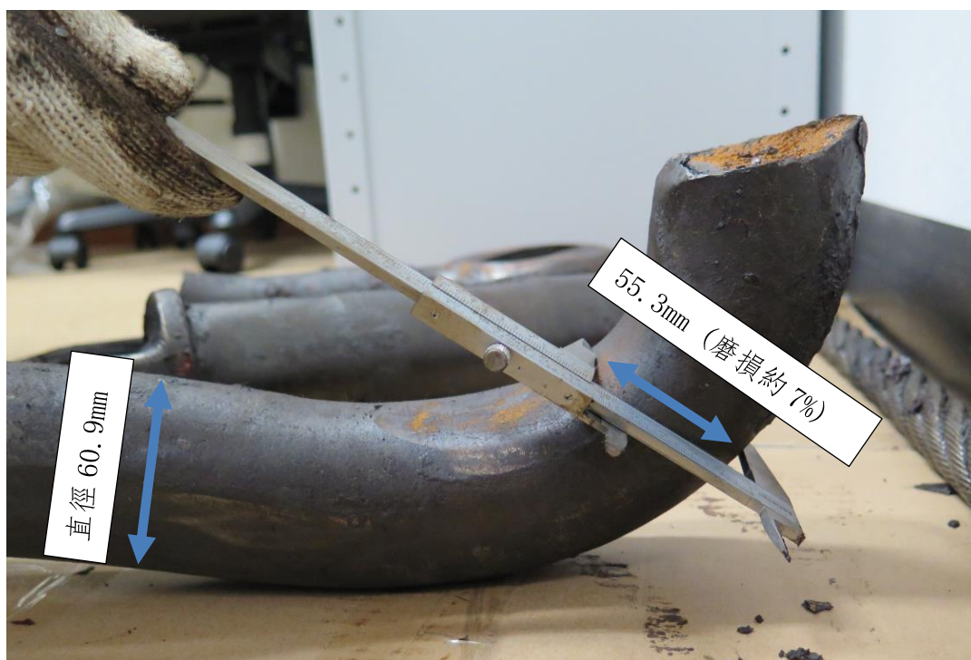
圖 5 - D 形接環直徑已磨損約 7%
