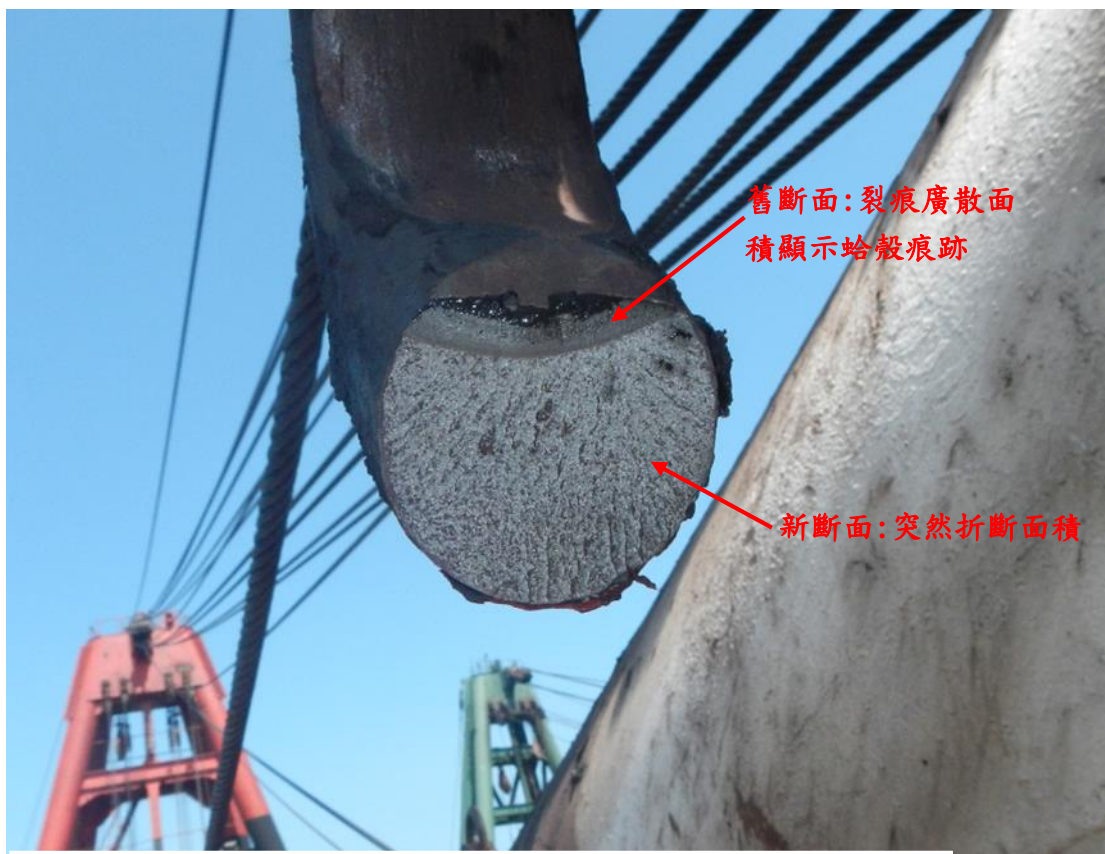
圖 4 - D 形接環的斷裂面
