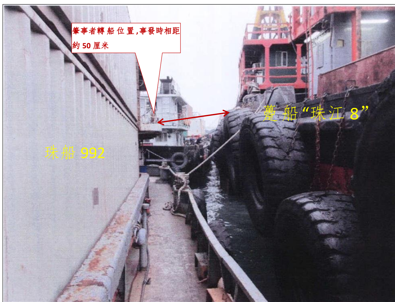
圖 3 . 事發後拍攝 (從船頭向後看), 兩船間空隙鬆開至超過 1 米。
