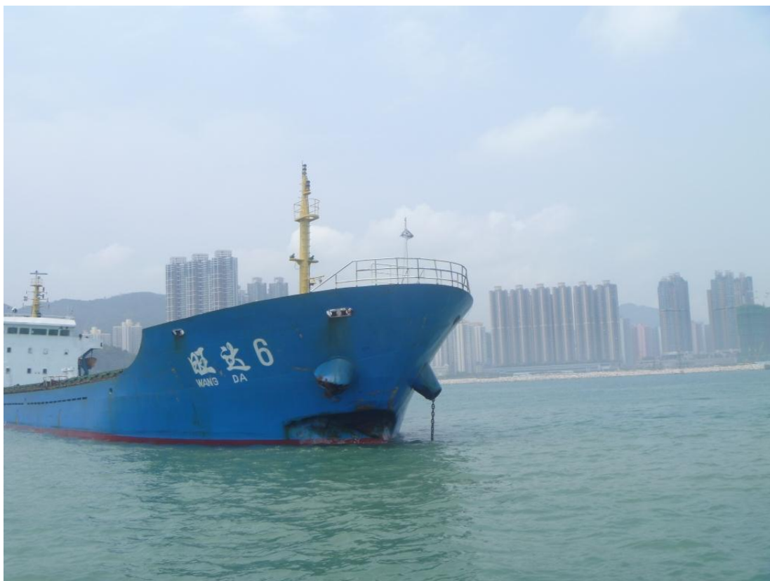
圖 4 “旺達 6”碰撞後船頭水線上破損，右錨丟失
