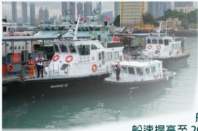
近日六艘新巡邏艇加入海港巡邏組（巡邏組），包括4艘長約15米的玻璃鋼艇—海事18、20、21和22及另外2艘長約10米的鋁合金雙體艇—海事113和115，這批巡邏艇以新的佈局建造並安裝了多項新設備，有助處方執勤人員加強管理海上交通。
