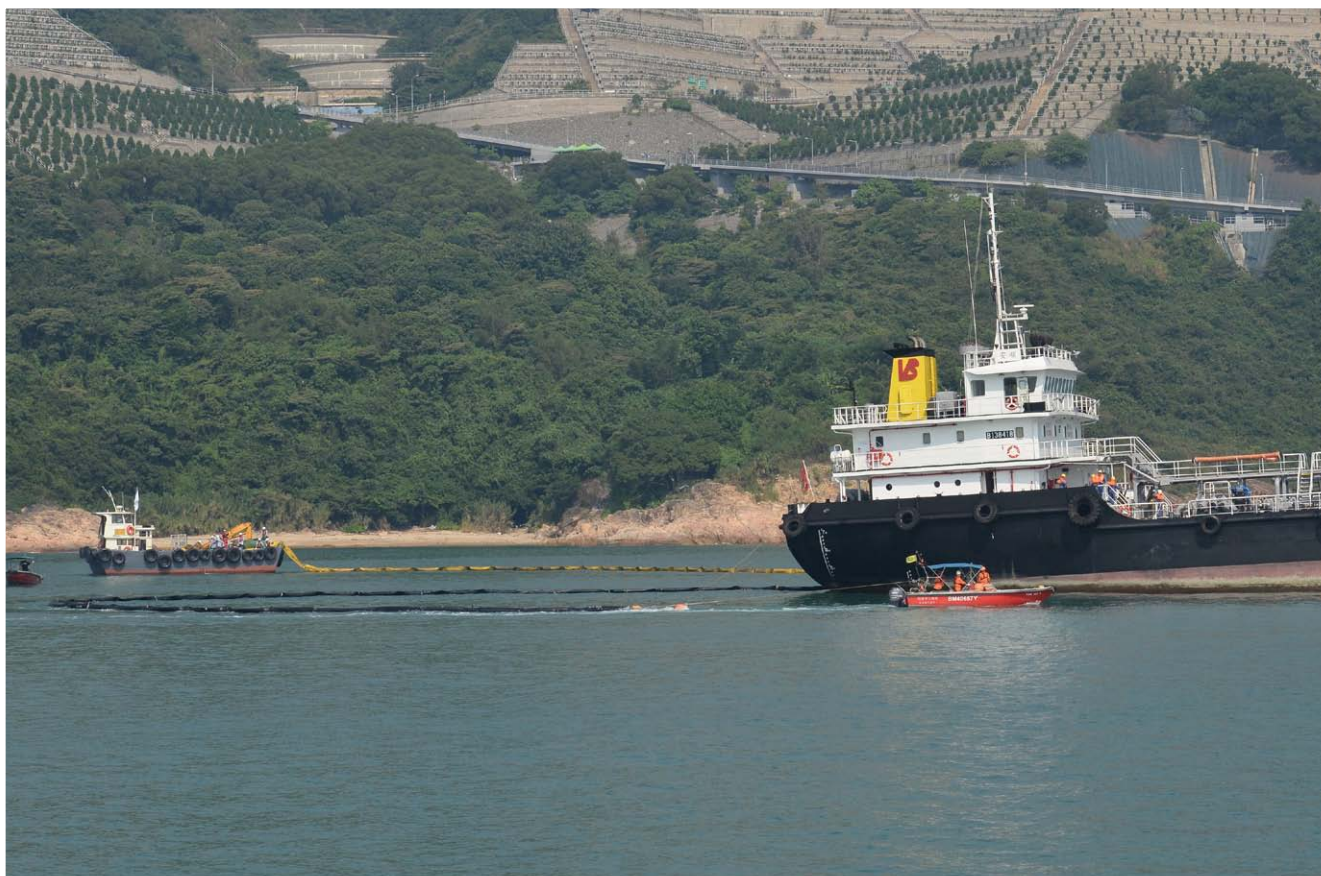
海事處在將軍澳海面舉行分別以「油演 2015」及「有毒有害物質溢漏演習 2015」作代號的周年海上污染事故聯合演習。圖示油污清理隊伍架設圍油欄，防止模擬油污擴散。
