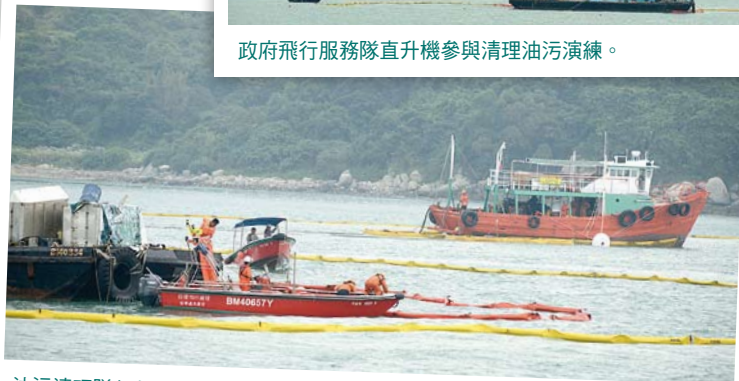
油污清理隊伍架設圍油欄，模擬防止油污擴散。
