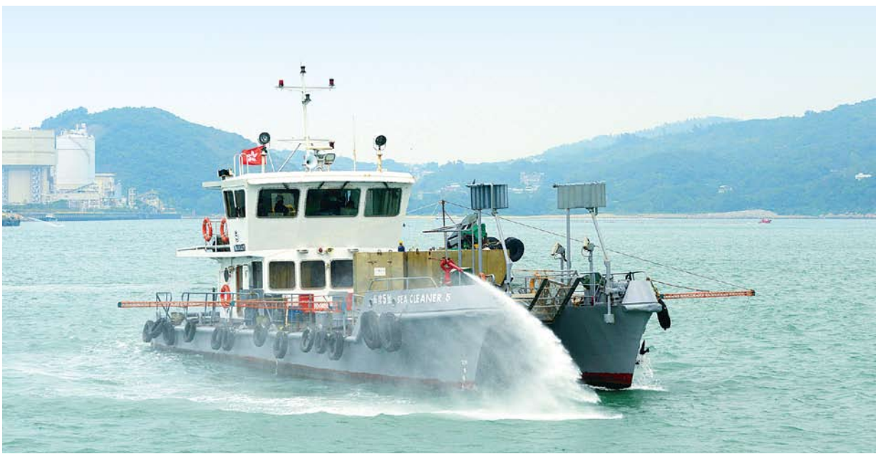
清污船隻模擬向漂散在海面的油污噴灑化油劑。
