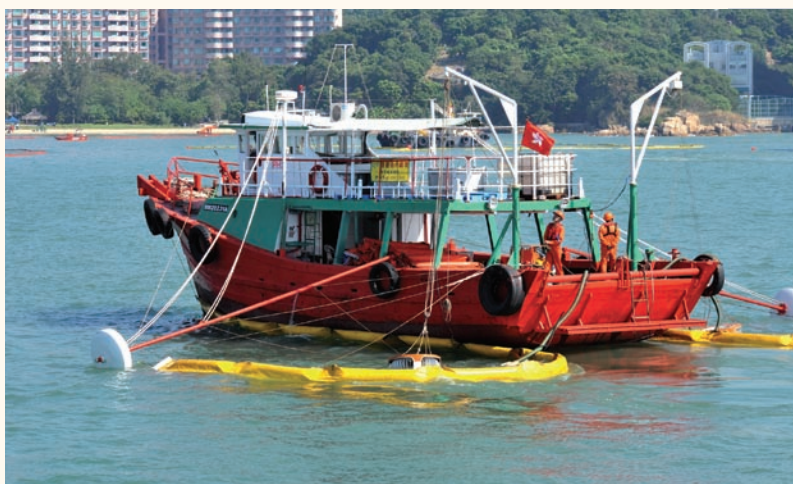
一艘船利用撇油器回收模擬海面燃油。
