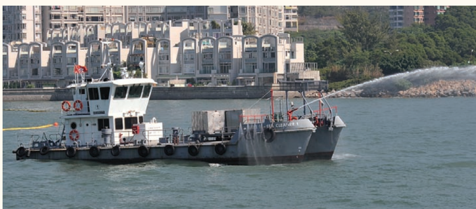
「海潔1號」噴灑模擬化油劑在「被油污染的海面」。
