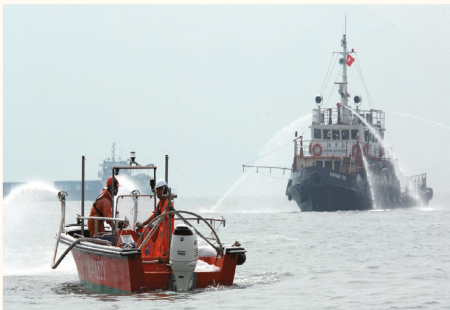
消防處滅火輪測試射水設備功能。
