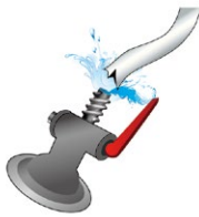
應時常操作通海閘門 檢查喉管洩漏，更換生鏽喉箍
