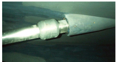
安裝在船底傳動軸的鋅塊
