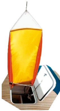
用一塊三角帆吊掛在船頭通風窗作風兜
