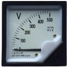
電壓錶 Voltage meter
