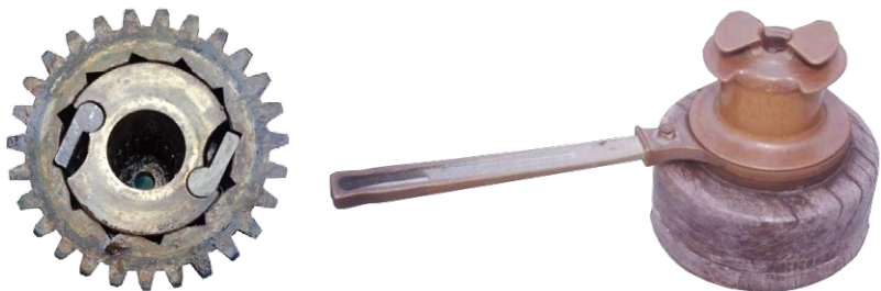
帆纜絞盤 — 單向棘爪 Pawl，令齒輪只可單向（反時針方向）轉動
